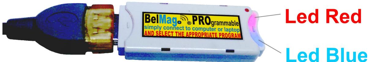
Slika: **BelMag PRO** uređaj na USB portu sa opisanom svetlosnom signalizacijom
