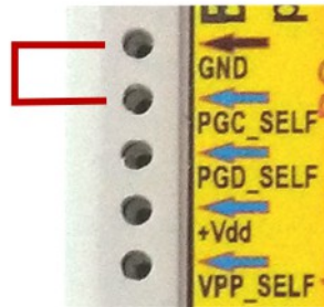
Slika 7. Konfiguracija za režim učitavanja/osvežavanja firmvera.
